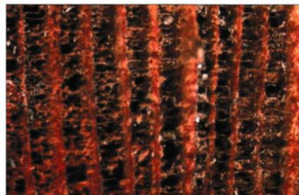
Abb. 7: Massive Moderfäule im Querschnitt: Frühholzanteile sind als Lamellen stehen geblieben, der Spätholzanteil ist zerstört.
