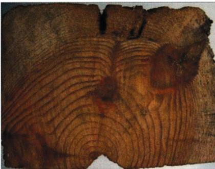
Abb. 53: Kiefernholz-Querschnitt. Fachwerkstiel mit intaktem Kernholz; Splintholz braunfaul und bereichsweise final zerstört; Balken herztrennt und rissfrei.
