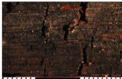
Abb. 6: Moderfäule mit Würfelbruch, der sich kaum von einer Braunfäule unterscheidet; Maßstab mit Millimetern.
