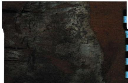
Abb. 26: Mycel des Echten Hausschwamms auf einer Dielenunterseite; typisches graues, lappiges Mycel mit Zuwachszone; Maßstab mit Zenti- und Millimetern.
