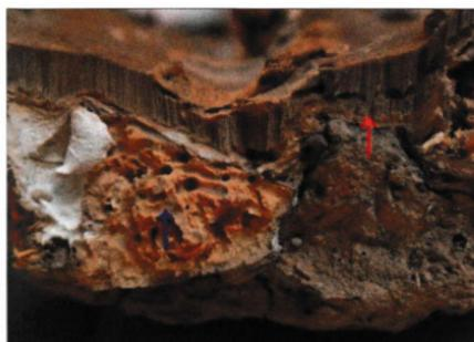
Abb. 30: Ausgebreiteter Hausporling: Fruchtkörper im Anschnitt [mit Lehmresten und Holz auf der Unterseite]; die Poren sind als feine Röhren sichtbar (†); Holz mit Larvengängen des Bunten Nagekäfers (†).
