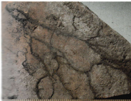
Abb. 30. Brauner Kellerschwamm an einem Ziegelstein, typische schwarze Stränge; Maßstab mit Millimetereinteilung
