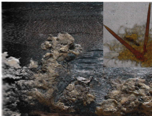
Abb. 16. Großporiger Feuerschwamm: ockerbraunes Oberflächenmycel; Eckbild: Setae sind 0,17 mm lang
