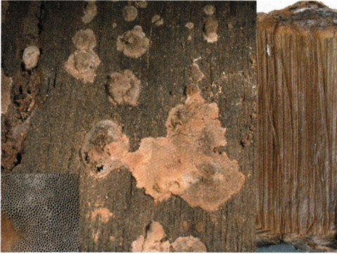
Abb. 10. Ausgebreiteter Hausporling, Fruchtkörper, links Übersicht, rechts Poren im Querschnitt; Eckbild: Poren
