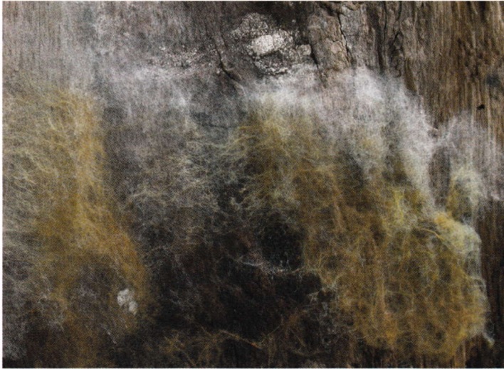
Abb. 1. Mycel an einem ausgebauten und bebrüteten Eichenständer: Ausgewachsen war ein Tintling ( Coprinus sp.); Bild ca. 25 cm breit.
