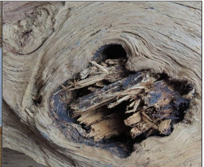
Abb. 49: Braunfauler Tot-Ast im Eichenholz. Durch Fauläste im Bauholz können Fäulepilze in Gebäude gelangen; Beispiel hier überzeichnet.
