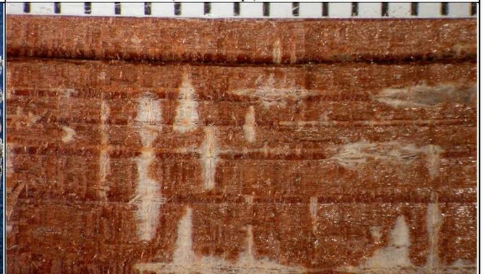
Abb. 13: Mehrfachbefall: Braun- und Weißlochfäule (z. B. durch Borstscheibling) an einer Schwelle; Maßstab mit Millimetern (oben).
