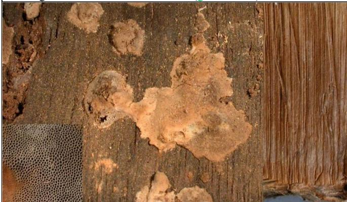
Abb. 29: Ausgebreiteter Hausporling (*Donkioporia expansa*), Fruchtkörper und Oberflächenmycel, links Übersicht, rechts Eckbild: graue Poren (4-5 je mm)
