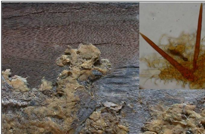
Abb. 50: Großporiger Feuerschwamm (*Phellinus contiguus*): ockerfarbenes Oberflächenmycel; Eckbild: braune, im Mycel wachsende Eckbild: braune, im Mycel wachsende Setae (kleine Dornen), bis 0,17 mm lang
