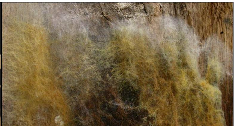
Abb. 7: Mycel (Ozonium) an einem ausgebauten und bebrüteten Eichenständer: Ausgewachsen war ein Tintling (*Coprinus* sp.); Bildbreite ca. 25 cm.
