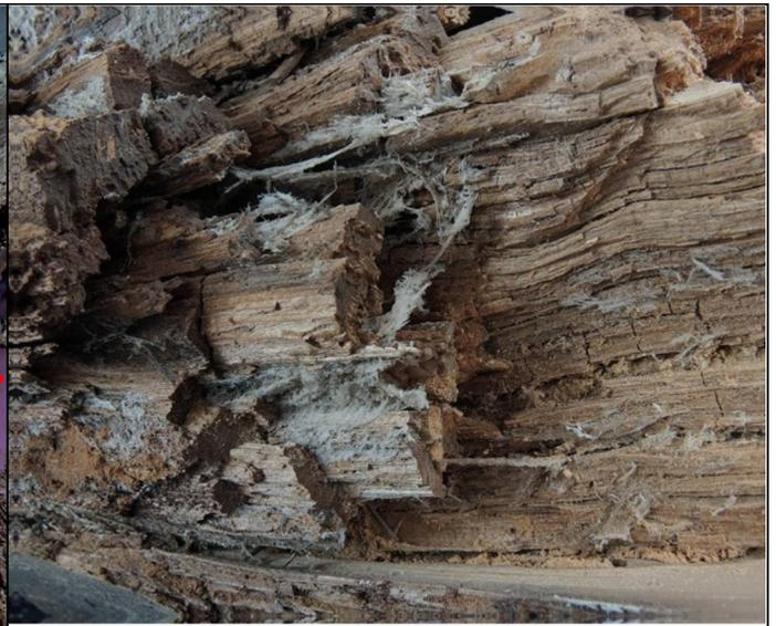
Abb. 45: Echter Hausschwamm (*Serpula lacrymans*): graues, lappiges Mycel und feine Stränge im Inneren eines Fachwerkstiels; intensive Braunfäule mit grobem und feinem Würfelbruch (ohne Insektenschaden).
