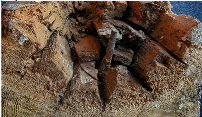
Abb. 12: Echter Hausschwamm (*S. lacrymans*): Braunfäule-Befall an einer Schwelle mit massiver Innenfäule auf der Unterseite.
