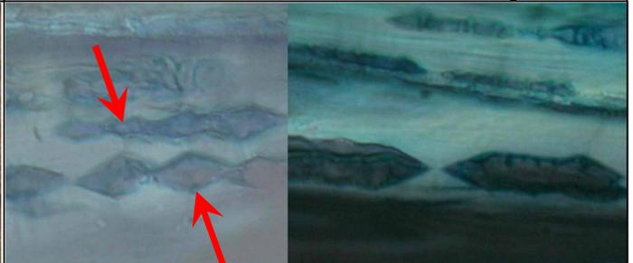
Abb. 21: Mikroskopische Aufnahme (ca. 1000fach); kavernenartige Zerstörungen (Pfeil) der Holz Zellwände durch Moderfäulepilze, das rechte Bild ist eine polarisationsmikroskopische Aufnahme.
