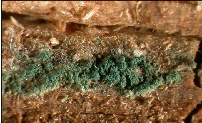
Abb. 94: Lupenbild (ca. 5-fach) – verschimmeltes Holzteil: Befalls-Detail des Grünen Holzschimmels (*Trichoderma viride*)
