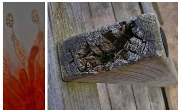
Abb. 21: Braunfäule-Schaden durch Gallertränen an einem Nadelholz von geringer Dimension; Bild links: Teile der gegabelten Basidie.
