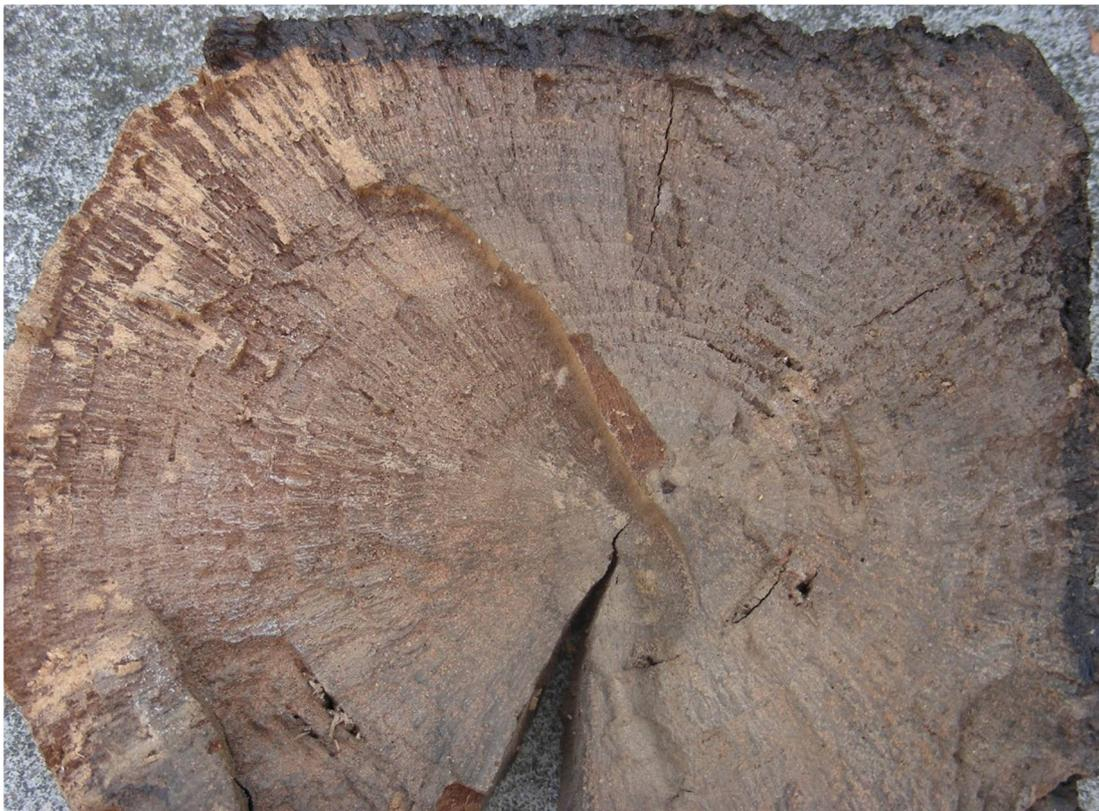
Abb. 13a: Moderfäuler Vierkant-Pfahl mit kurzfasrigem (stumpfem) Bruchbild; Teile des Querschnittes sind im Randbereich abgebrochen.
