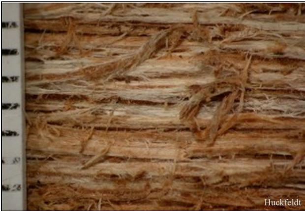
Abb. 1: Weißfäule, verursacht durch den Ausgebreiteten Hausporling (*Donkioporia expansa*), Holz deutlich faserig; Millimeter-Maßstab.
