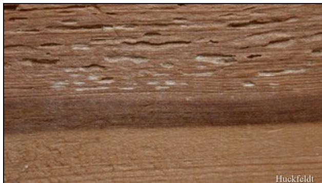
Abb. 5: Bauholz - Sortierungsfehler: Kiefernholz mit WeißloCHFäule (Form einer WeißFäule), verursacht durch einen Kiefernchwamm, auch Kiefern-Feuerschwamm (*Phellinus pini*); intakte Bereiche wechseln sich mit zerstörten ab.
