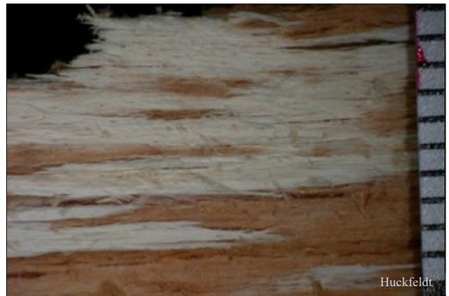
Abb. 2: Selektive Weißfäule, verursacht durch den Zunderschwamm (*Fomes fomentarius*); in den weißen Bereichen ist das Lignin vollständig abgebaut; Maßstab mit Millimetern.
