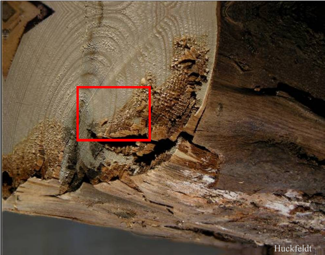
Abb. 1: Lagerholz mit Braunfäule; Mycel fehlt; Probennahme vom gesunden Holz mit Übergang zum zerstörten entnehmen.
