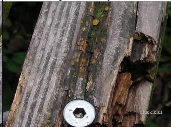
Abb. 4: Detail von Abb. 3: Ein günstiges Stück zur Probeneinsendung oder gern mehr Material schicken. Die kleinen gelben Fruchtkörper mit einsenden.
